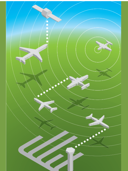
Das Ifats-Konzept im Überblick. Das Bild zeigt die verschiedenen Teilnehmer am Luftverkehr, die über Datenverbindungen untereinander und mit dem Boden kommunizieren. Datenverbindungen und bordseitige Sensoren sind symbolisch dargestellt
